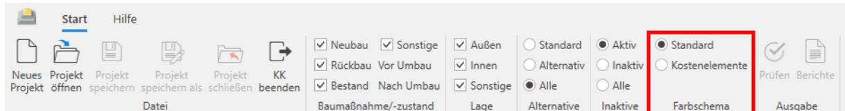
Das Farbschema kann sinnvoll für die Kontrolle des Projektes eingesetzt werden, da die Bauteile mit der Farbe des zugewiesenen Kostenelementes dargestellt werden.
