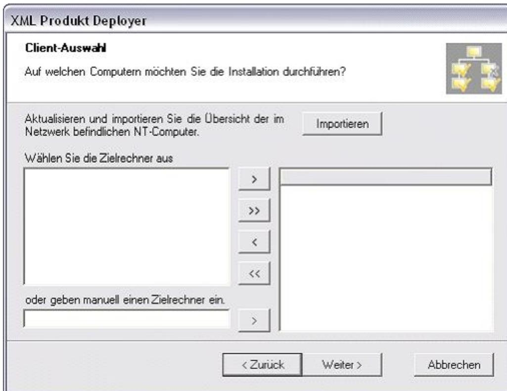
In vielen Fällen werden die im Netz existierenden Rechner automatisch erkannt. Dann ist die linke Liste gefüllt. Sie müssen nur die betreffenden Rechner auswählen und in rechte Liste verschieben. Wird die linke Liste nicht automatisch gefüllt, dann müssen die betreffenden Rechnernamen in das linke untere Feld eingegeben und in die rechte Liste verschoben werden.
