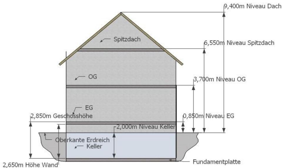
Der erste Projektteil, der angelegt wird, erhält automatisch das Niveau 0m. Liegt die Fundamentplatte/Bodenplatte tiefer, sind auch negative Werte erlaubt. Gemessen wird ab Oberkante Fundamentplatte. Das Niveau eines Projektteils kann sowohl in positive als auch negative Richtung verschoben werden.
