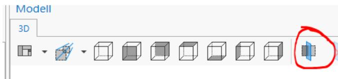
Durch einen Mausklick auf das Schnittwerkzeug wird eine zur aktuellen Perspektive parallele Schnittebene erzeugt. Sie ist sichtbar, wenn man das Gebäude nach dem Klick etwas dreht. Die Lage des Schnittes kann durch Bewegung des Schiebereglers angepasst werden.
