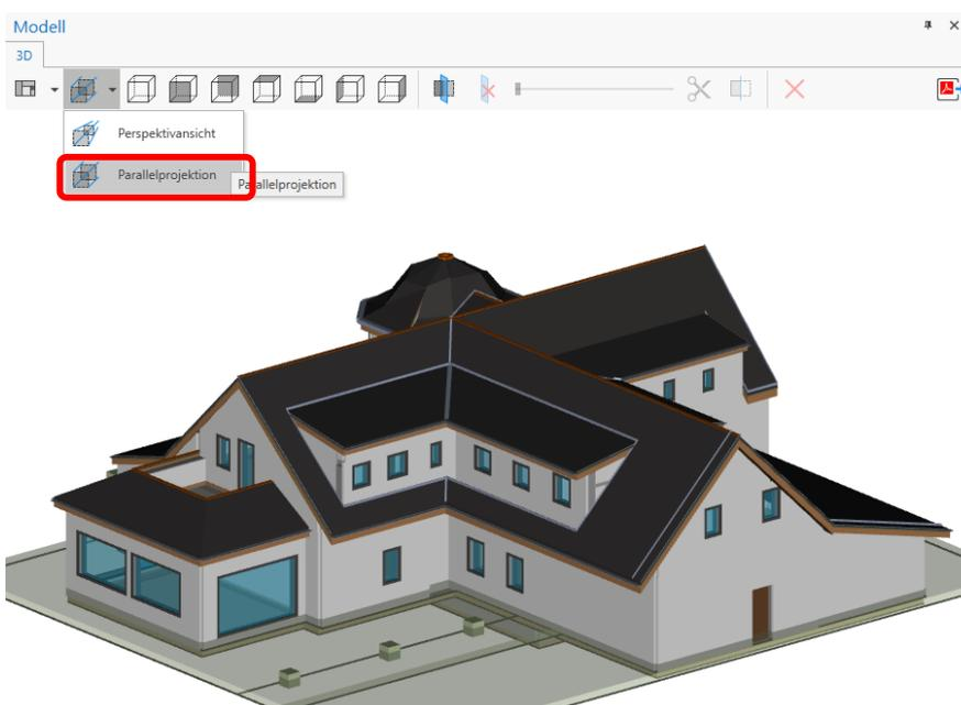
Die Parallelansicht eignet sich für die Kontrolle der Lage von z.B. Wänden in dem gesamten Projekt.
