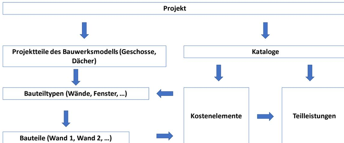
Das Arbeitsprinzip von DBD-KostenKalkül beruht auf einer sehr engen Verbindung des Bauwerksmodells (Mengen) mit den Kosten- und Leistungsinformationen der Kataloge. Durch diese Verbindung entstehen aus Bauteilen und Kostenelementen automatisch Kostenobjekte, in Form von Kostenberichten von der Kostenschätzung bis zum verpreisten Leistungsverzeichnis, als Basis für die Leistungsbeschreibung (AVA) oder als Basis für die Baubetriebsrechnung (Kalkulation) genutzt werden können.
