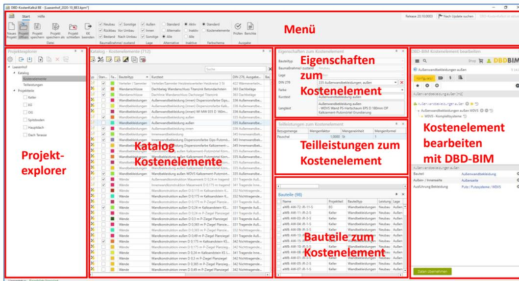
Ist die Auswahl im Projektextplorer auf Teilleistungen gesetzt, kann der **Katalog Teilleistungen** bearbeitet werden.
