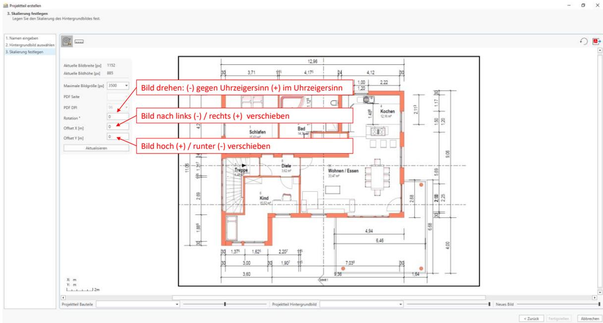
Über die Rotation wird das Hintergrundbild gedreht. Mit Offset X erfolgt eine Verschiebung nach links/rechts. Über Offset Y erfolgt eine Verschiebung nach oben/unten. Es sind positive und negative Werte zulässig. Die notwendige Verschiebung kann mithilfe des Messwerkzeugs
