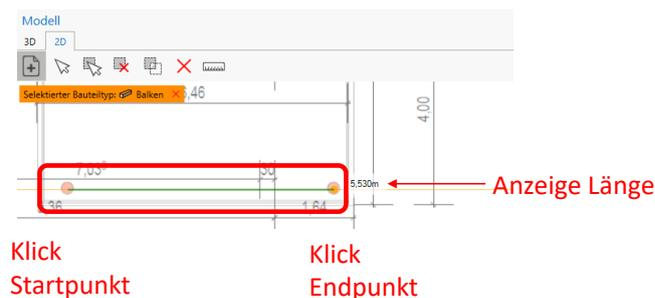
Der Endpunkt kann als Alternative zum Mausklick auch durch Eingabe der Länge festgelegt werden. Die Richtung der Linie wird durch Bewegung mit der Maus vorgegeben. Durch Drücken der rechten Maustaste erscheint ein Fenster, in das die gewünschte Länge der Linie eingegeben werden kann.
