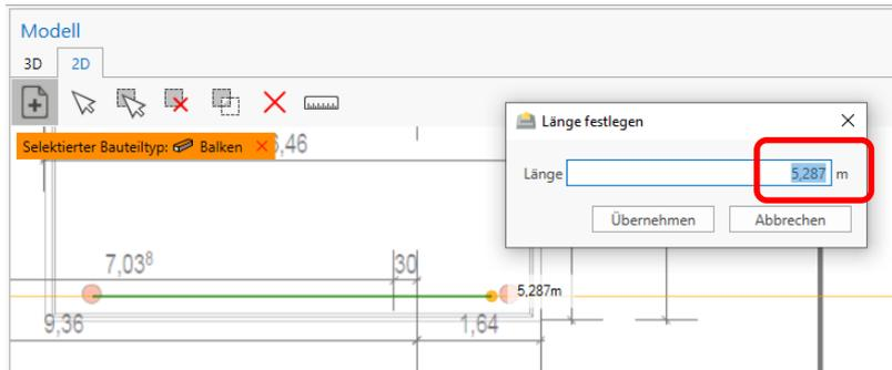
Das Fenster ist mit der aus der Cursorposition errechneten Länge vorausgefüllt. Die Länge kann geändert und übernommen werden. Im Anschluss entsteht die Linie. Übersicht aller Linienbauteile siehe Tabelle in Kap. 12.
