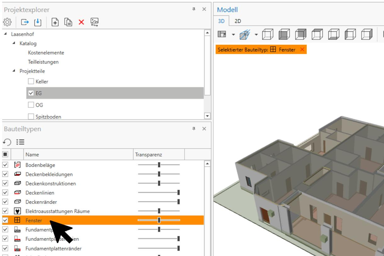
Dies ist erkennbar durch den orangefarbenen Balken. Damit sind im 2D/3D Modell nur noch Bauteile des selektierten Typs auswählbar. Des Weiteren ist der Bauteiltyp im 2D automatisch für die Platzierung weiterer Bauteile ausgewählt.
