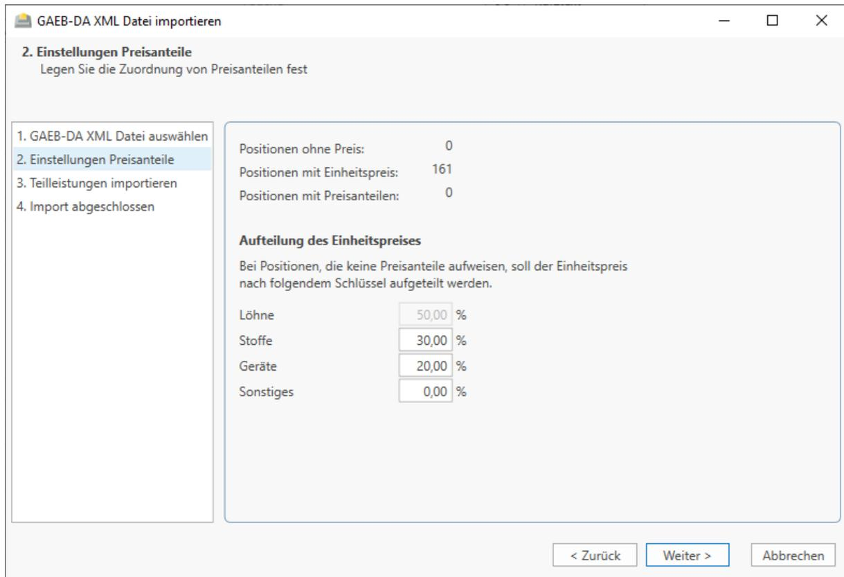
Da DBD-KostenKalkül die Einheitspreise intern in die Preisanteile Löhne, Stoffe, Geräte und Sonstiges untergliedert, werden Einheitspreise aus der GAEB-Datei nach einem einstellbaren Schlüssel aufgeteilt, sofern keine Preisanteile in der GAEB-Datei vorhanden sind.
